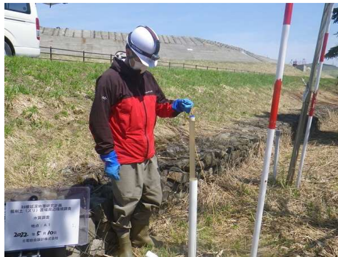
掘削土(ズリ)置場周辺環境調査 地下水採水状況
