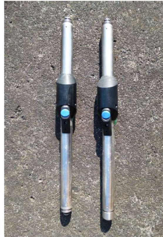
ボーリング孔の中に設置している 水圧計(MOSDAXプローブ)
